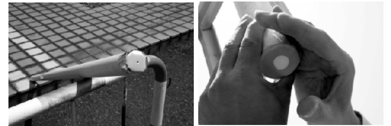
科学館で製作したピンホールを利用した日食観測器 手元に太陽像が映し出されている。 （筒の両側に穴を開けたアルミホイルと紙を貼る）
